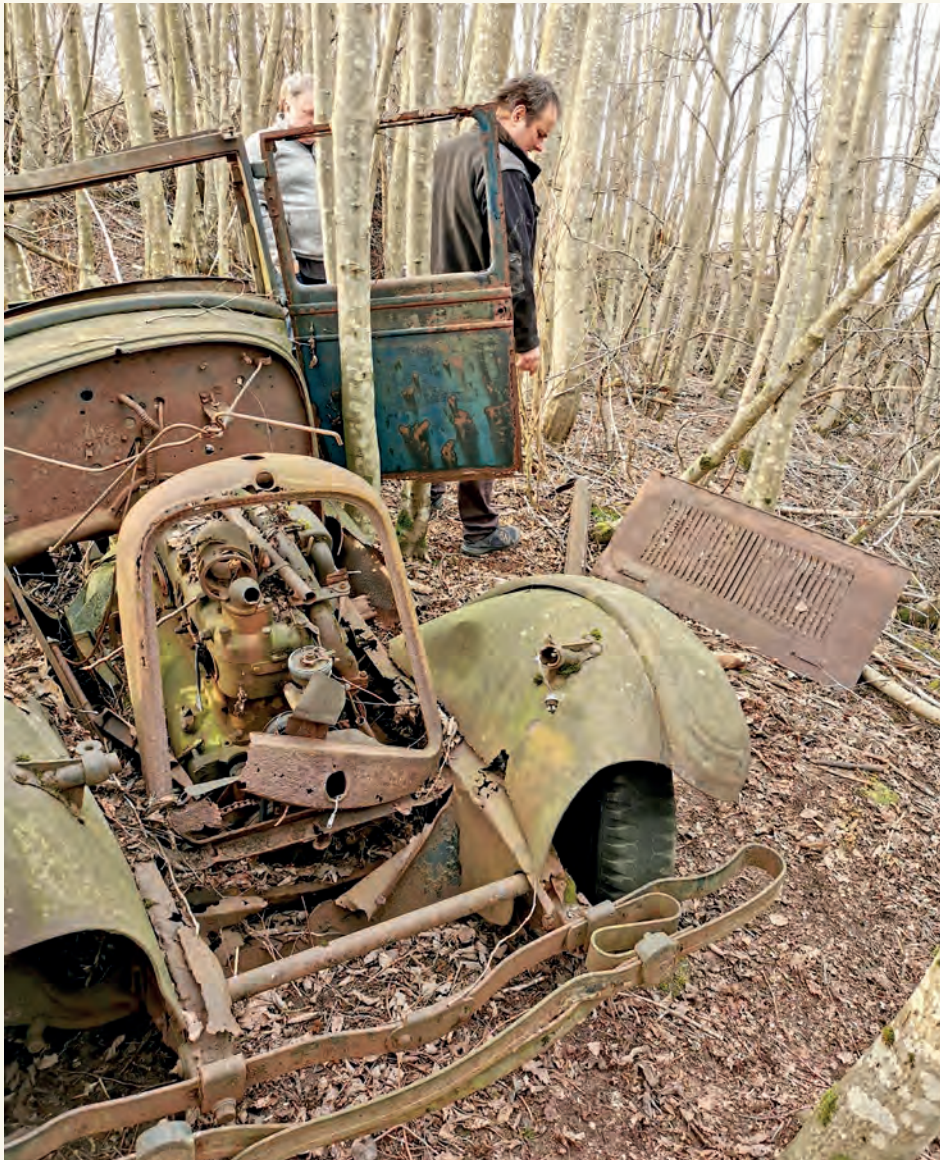
Motoren i en President var en 6-sylindret sak på hele 354 kubikktommer, altså over 5 liter, som utviklet 75 hk.
