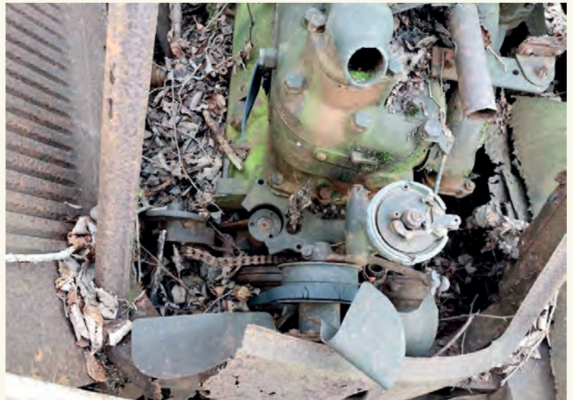
Bilen har noen spesielle løsninger som kjededrevet dynamo og det som ser ut som en fordele, begge plassert i framkant av motoren.
